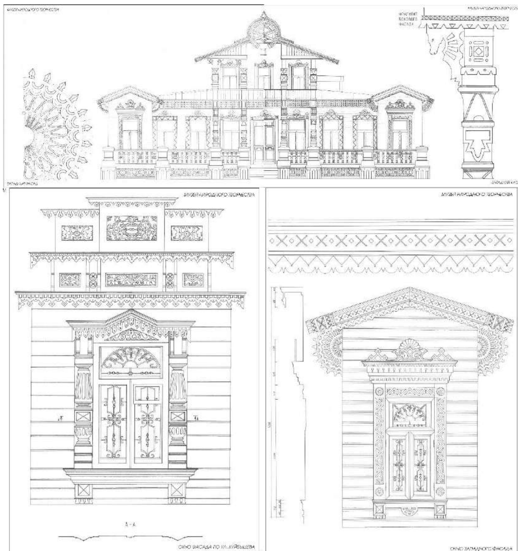
Рис. 9. Усадьба Загоскиных в Пензе. Фасад. Деревянная резьба. Наличники окон. Чертежи (Лапшина, 2019)
