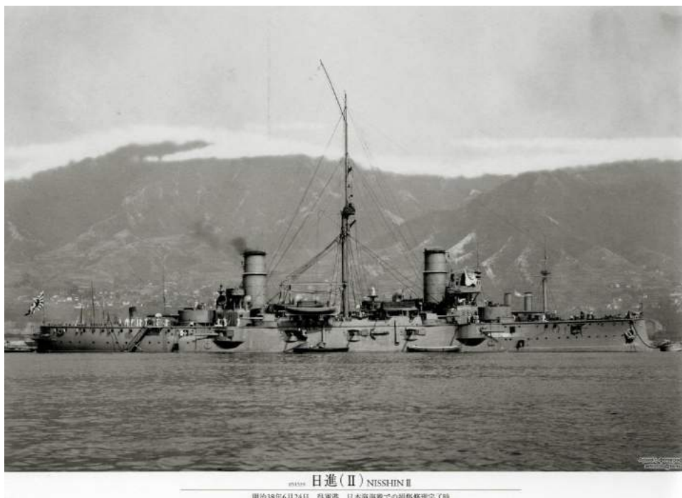
Рис. 7. Броненосный крейсер «Ниссин» (1903) – «карманный линкор» японского флота, образец эффективности использования веса корабля в угоду первичным, но в ущерб вторичным боевым качествам
