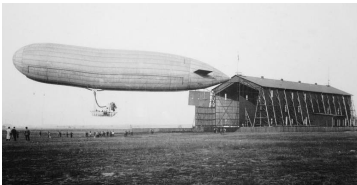
Рис. 3. Дирижабль с полумягкой оболочкой. Дирижабль Парсевалья
